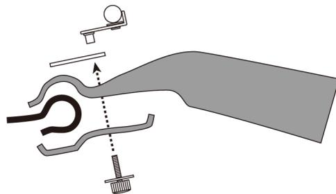
・ワンストローク・ポジション・・・スクイジーとシャンプーが同じ方向を向く取り付け方です。一回のストロークでシャンプーがけとスクイジーによる水切りを行います。
