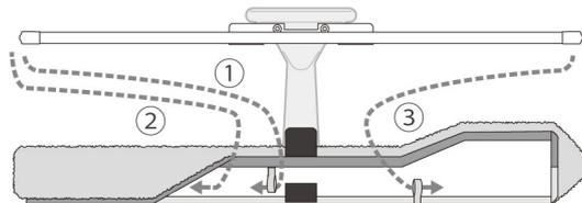
①のゴムは、パイプとL型台座の両方を通し、図の位置になるようにします。台座とパイプが外れてしまうような万が一の場合に、シャンプー部分が落下するのを防ぎます。必ず通してください。
